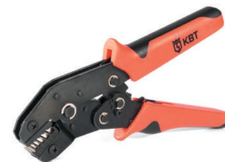
“Миниатюрная 8-дюймовая обжимка для втулочных наконечников с храповым механизмом и двумя матрицами сечением от 0.25 до 16 мм<sup>2</sup>.”
